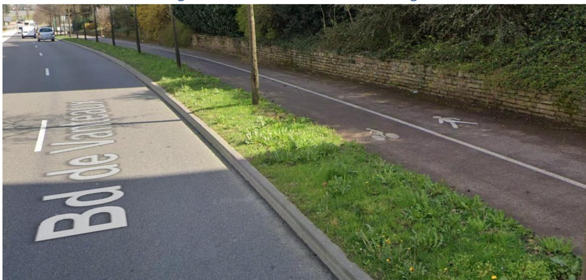
L'aménagement réalisé sur cette section est correct, avec deux unidirectionnelles séparées des piétons par des bandes de peinture. Lors de la prochaine réfection des trottoirs, il faut envisager une différence de niveau de 5cm entre le trottoir et la piste cyclable.
